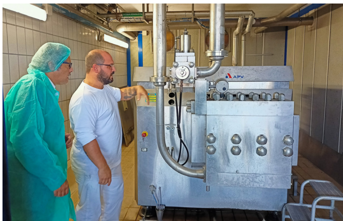
Il pastorizzatore Ultima fase del processo: il latte viene fatto girare nella macchina a 95 c°, poi raffreddato con un sistema a piastre
