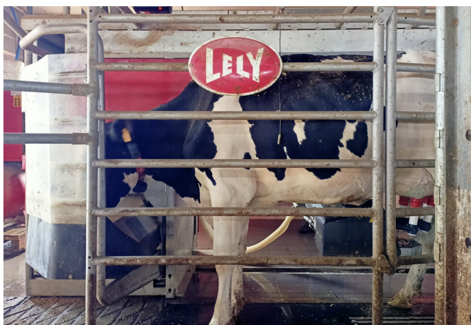
Il robot di mungitura Quando la mucca entra nel macchinario, inizia la mungitura, che è automatizzata e non richiede intervento umano
