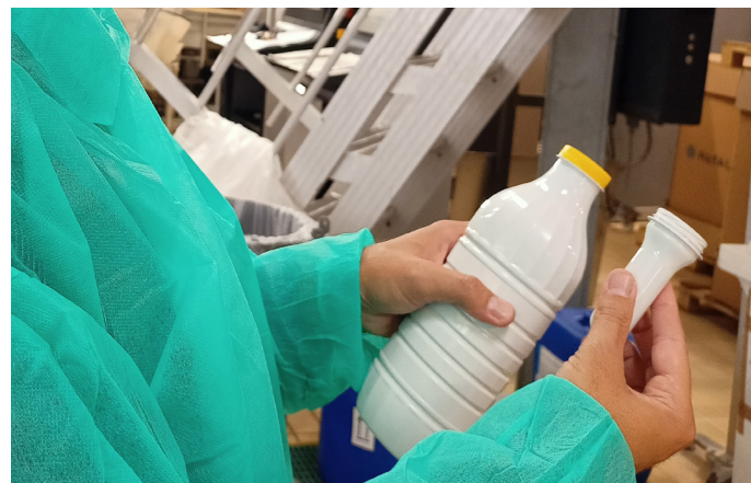
L'imbottigliamento Il "prima" e il "dopo" dell'imbottigliamento: dal flacone in plastica alla bottiglia vera e propria
